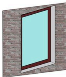
Fensterbank nicht vorhanden
