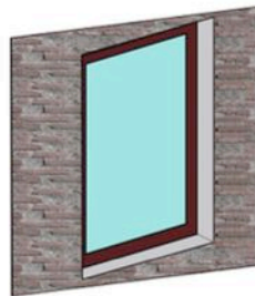
Fensterbank nicht vorhanden
