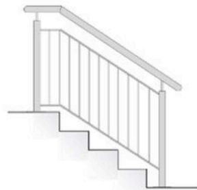
Treppengeländer Edelstahl FS Stabfüllung
