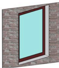
Fensterbank nicht vorhanden
